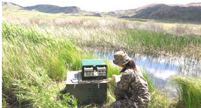
Рисунок 4 – Отбор проб воздуха с помощью коллектора трития
