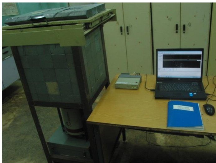
Рисунок 6 – Гамма-спектрометрические измерения образцов
