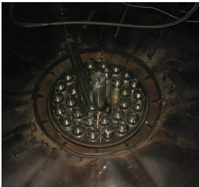
Рисунок 5 – Загрузка ЭУ с образцами в реактор для эксперимента
