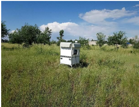
Рисунок 2. Отбор проб воздушных аэрозолей с использованием стационарного пробоотборника воздуха «Бриз»
