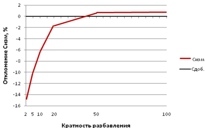
Рисунок 1. Влияние степени разбавления на определение концентрации урана
