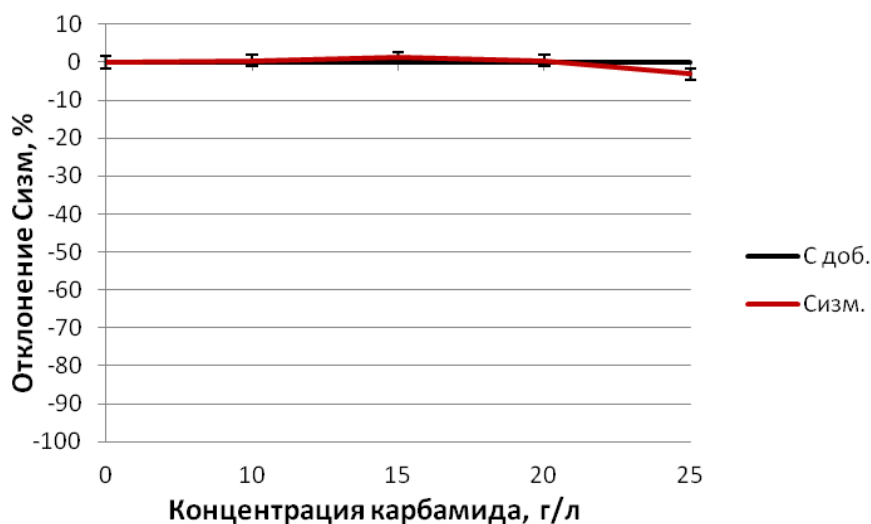
Рисунок 4. Влияние концентрации карбамида на определение урана в моче
