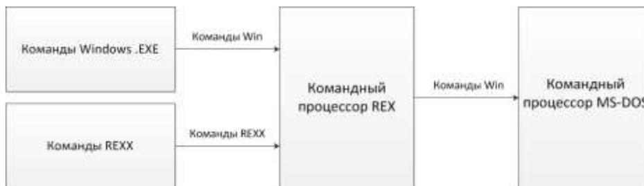
Рисунок 13 Среда командной обработки REXX
