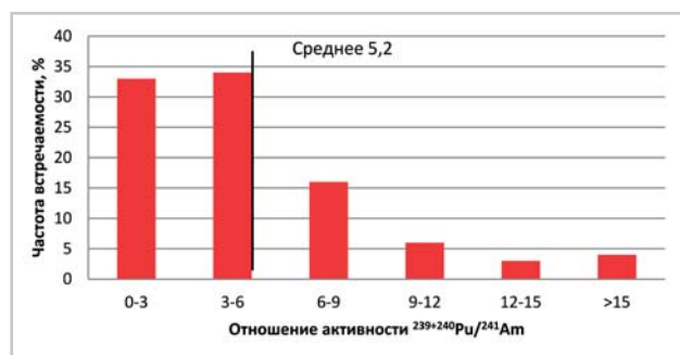
Рисунок 90. Распределение отношений удельной активности ^{239+240}\text{Pu} к ^{241}\text{Am} в почве «фоновых» территорий
