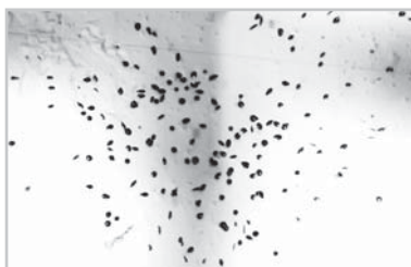
Рисунок 116. Фрагмент детектора, экспонированного над препаратом фракции почвы 500–250 мкм, отобранной на следе термоядерного взрыва 1953 г.
