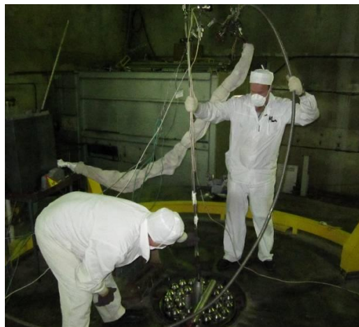
Рисунок 9 – Загрузка ампульного устройства в ФКЭ ИВГ.1М
