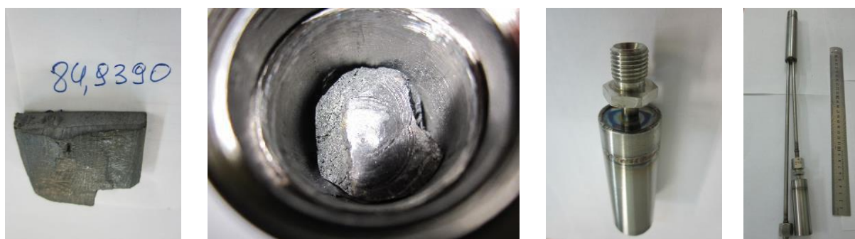
Рисунок 5 – Заливное устройство с загруженной эвтектикой и экспериментальная ячейка
